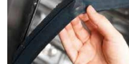
La junta es fácilmente extraíble para su sustitución y ayuda en las tareas de limpieza y mantenimiento.
