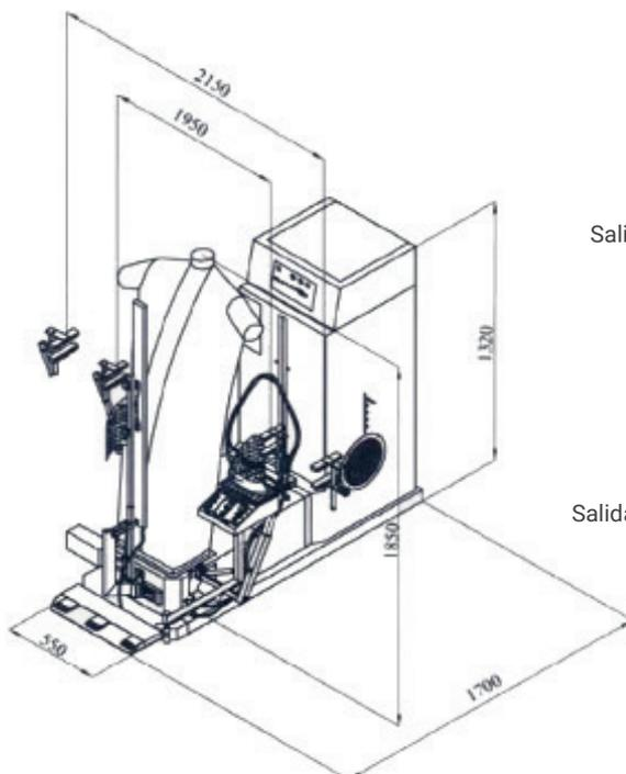
Aire comprimido 1/4": Presión aconsejada min. 4 Bar - max. 7 Bar
