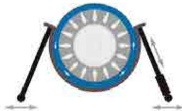
Hydraulisches System zum Anheben der Mulde
